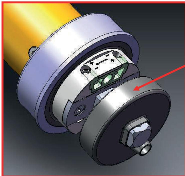
Capuchon souple dégagé, laissant apparaître les 2 molettes de réglage
