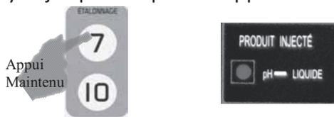
pH + : il faut éteindre l'appareil, attendre 5 secondes et maintenir la touche 10 appuyée, rallumer l'appareil et garder la touche appuyée jusqu'à ce que le + apparaisse.
