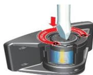
Utilisez un tournevis pour retirer la vis et le capuchon du haut de la charnière. A l'aide du tournevis à tête plate, appuyez sur le mécanisme de réglage à ressort et faites le tourner, comme indiqué sur l'illustration, afin de lui permettre de se repositionner à l'endroit désiré dans le manchon hexagonal. Assurez-vous que la tension soit identique sur les 2 charnières
