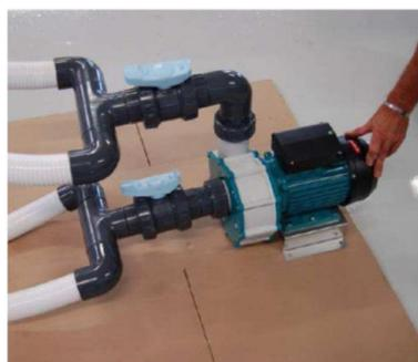
**ETAPE 4 – Fonctionnement :** Une fois la JETVAG installée, vérifier le sens de rotation du moteur de la pompe (si pompe triphasée). La JETVAG dispose d'un système breveté de réglage de débit d'eau et d'air agissant simplement sur la buse frontale.
