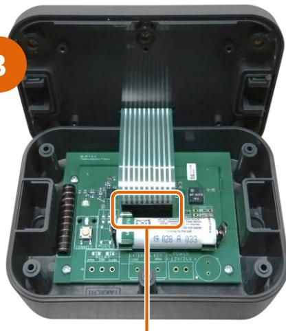
La télécommande doit être alimentée en  $\approx$ 3.6V continu par une batterie lithium modèle LS14500 de marque SAFT.
