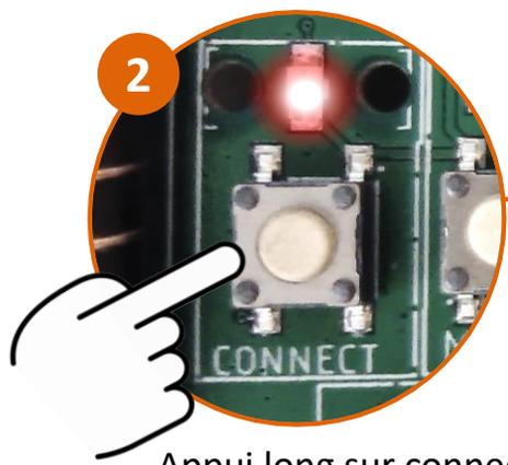
Appui long sur connect jusqu'à clignotement → Appairage en cours
