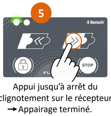
5 Appui jusqu'à arrêt du clignotement sur le récepteur → Appairage terminé.
