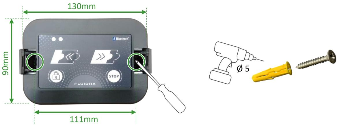
Installer la télécommande à une hauteur inférieure à 2m.
