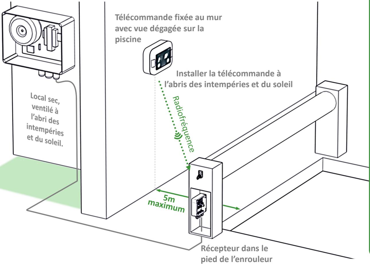
Afin de garantir les meilleures performances du produit, positionner le récepteur au plus proche du capot plastique dans le pied de l'enrouleur.
