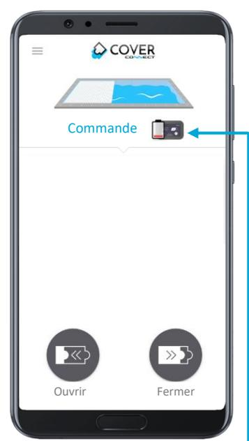
Si ce pictogramme apparait, remplacer la batterie de la télécommande
