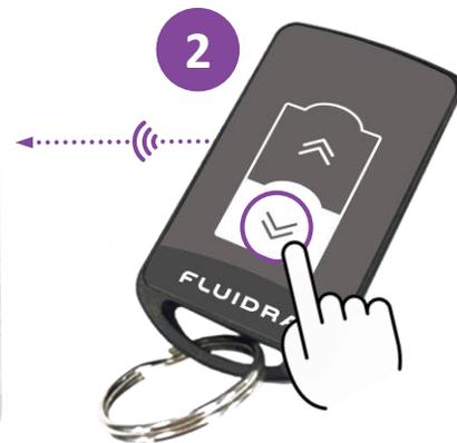
Appui jusqu'à arrêt du clignotement (appairage terminé)
