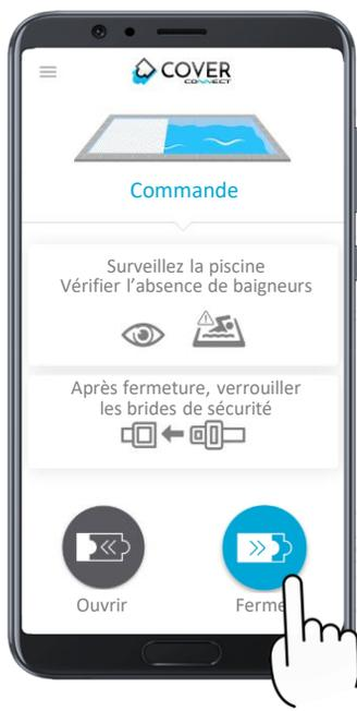
**Maintenir l'appui sur ouvrir/fermer pour actionner la couverture**
