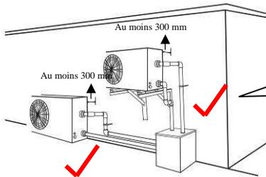
*L'appareil doit toujours être raccordé avec un tuyau rigide !*
