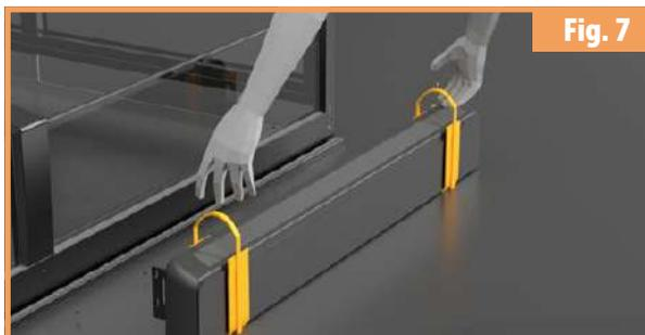
Saisissez l'appareil par les sangles et déposez-le à l'endroit où vous souhaitez le monter. (Montez le MOOVER sur le plus grand module de l'abri : **ne le montez en aucun cas sur la porte coulissante**)
