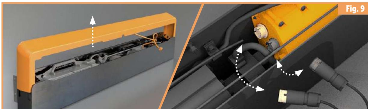
**Faites glisser le capot supérieur vers le haut pour le retirer et branchez les connecteurs du panneau solaire (en beige) et du panneau LED (en gris foncé) de l'unité de commande.** ATTENTION ! Tirez sur le connecteur, pas sur le câble. Le câble risquerait d'être endommagé ! Placez le capot et la batterie dans un endroit sûr afin qu'aucun dommage ne soit causé lors d'une manipulation ultérieure.
