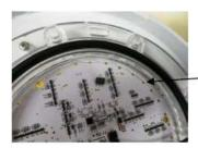
Positionner la carte LUMIPLAT à l'intérieur de l'optique. Il est nécessaire de la coller sur le pourtour pour la maintenir fixée.
