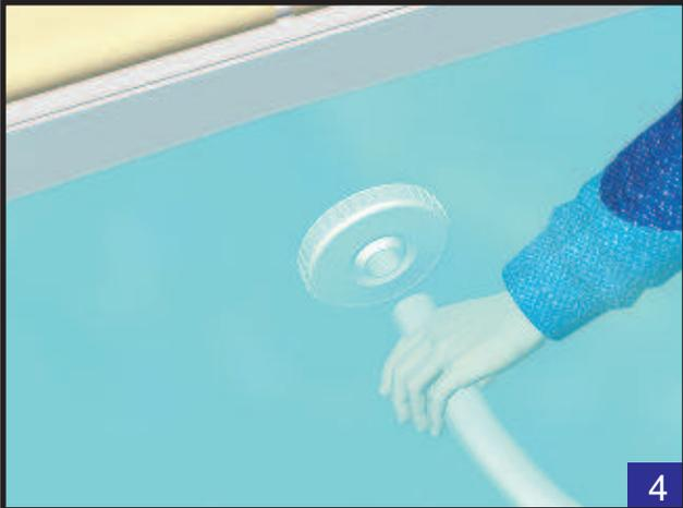
Positionnez l'extrémité du tuyau d'aspirateur devant une buse de refoulement de façon à chasser l'air.
