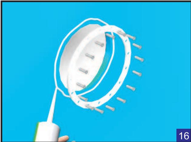
Déposez un gros cordon de mastic colle d'étanchéité à l'emplacement de la niche et de la bride puis assembler.
