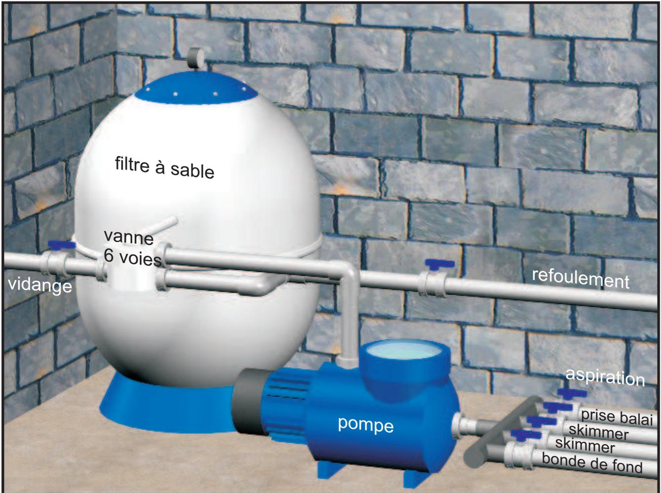
Installez le local technique et raccordez l'ensemble de la tuyauterie.
