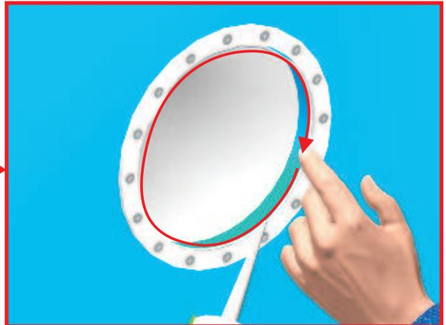
Comme pour les pièces à sceller, réalisez un joint mastic à l'intérieur de la bride.
